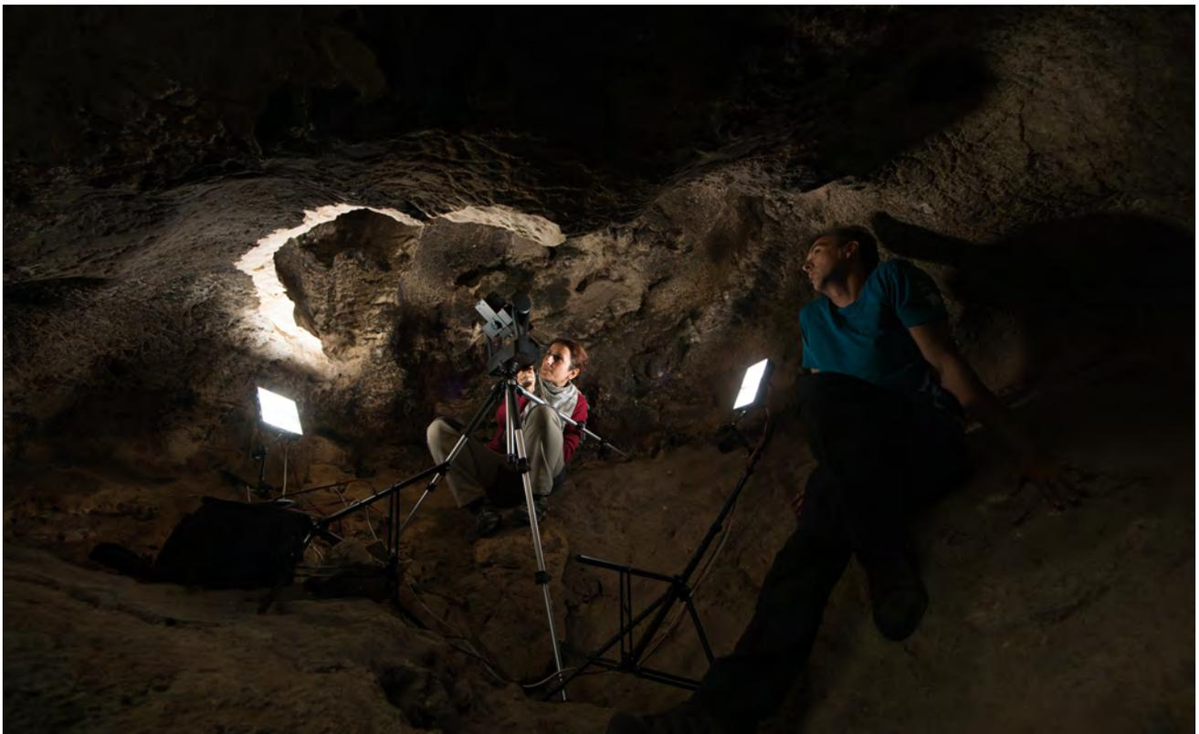
Fig. 122. Proceso de captura de una imagen gigapíxel con iluminación LED en Cueva de las Cabras 1B (JFR).
